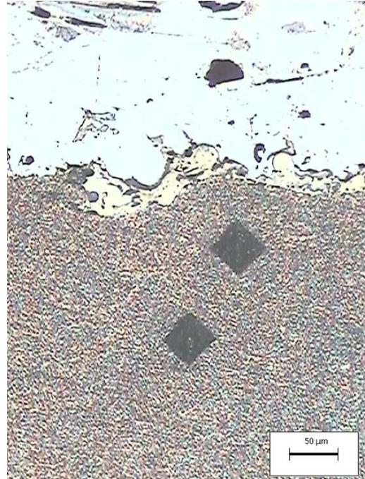
Dépôt de 715  $\mu\text{m}$  d'épaisseur en molybdène avec couche d'accrochage
