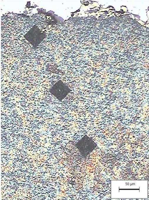
Dépôt de 308  $\mu\text{m}$  d'épaisseur en molybdène avec couche d'accrochage
