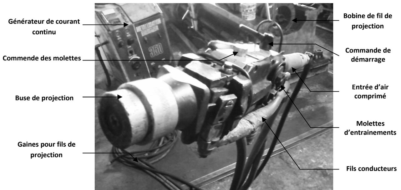
Le pistolet utilisé est un modèle THRMO-SPRAY 234 d'un poids relativement faible ce qui facilite sa manipulation donnant ainsi des dépôts de qualité même pour les pièces les plus complexes.
