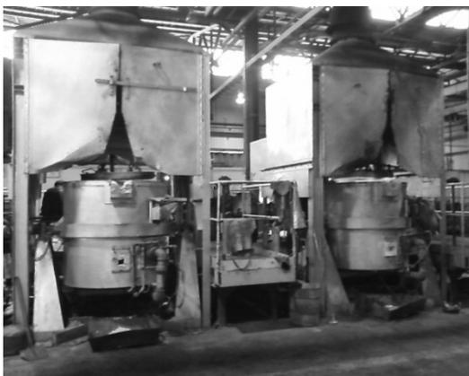
Figure II-1. Fours de fusion (S.N.V.I.).
