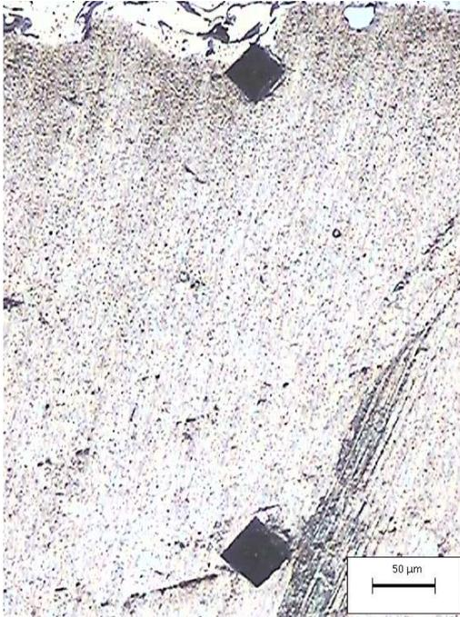
Dépôt de 259 µm d'épaisseur en acier inox 55 E avec couche d'accrochage
