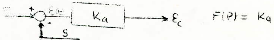
Fig II.1 - schéma fonctionnel d'un régulateur proportionnel.
