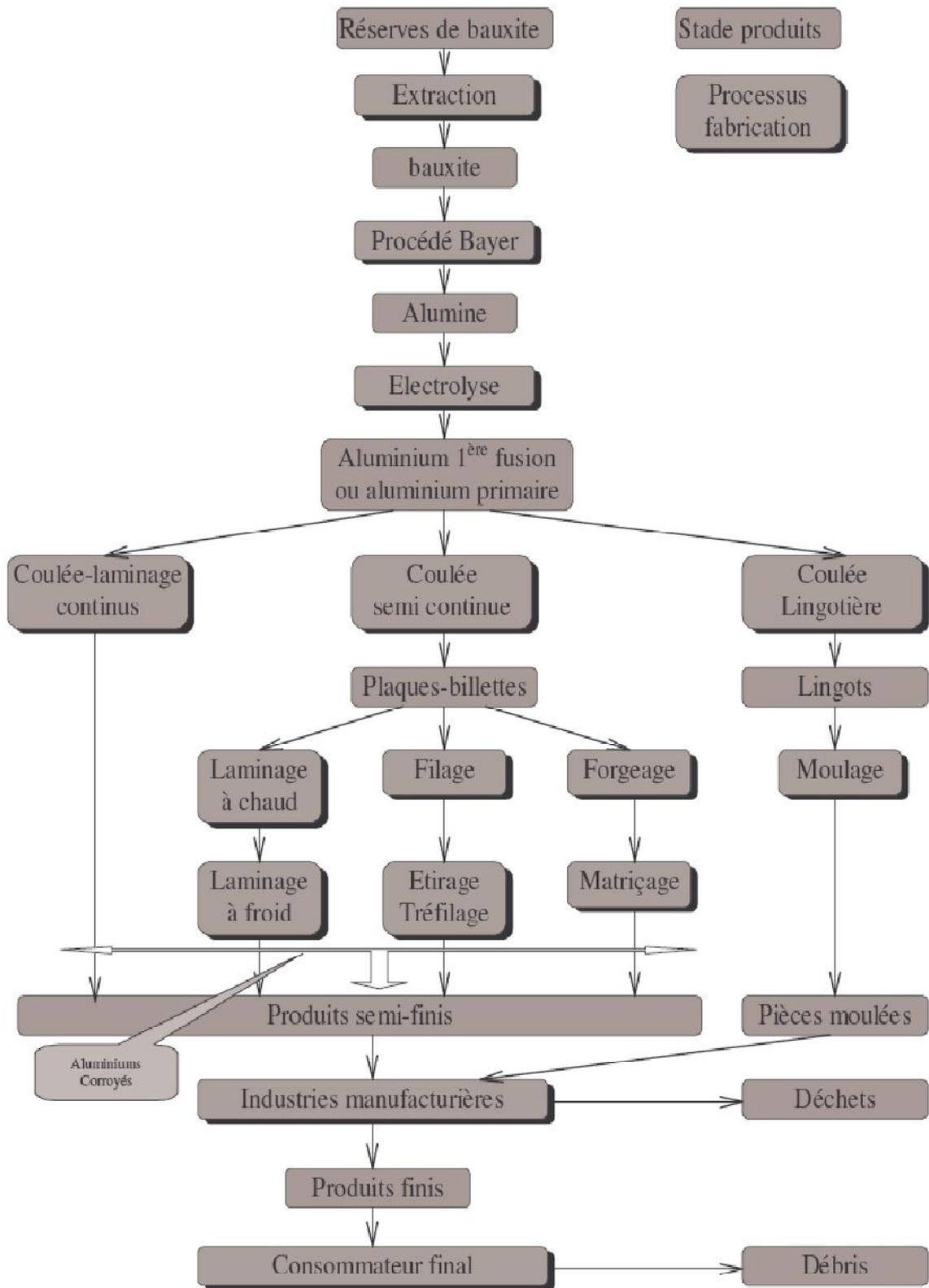
Figure 1. Principaux stades dans la fabrication de produits en aluminium [1].
