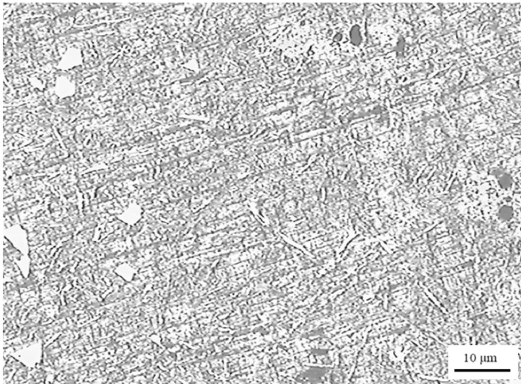
**Figure 41.** Structure de l'alliage AS13 coulé au laboratoire.
