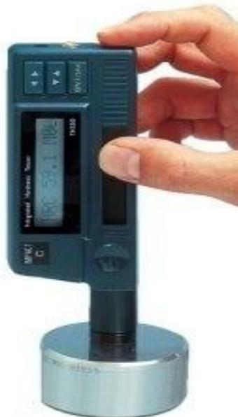
Figure 24. Appareil de mesure de la dureté.
