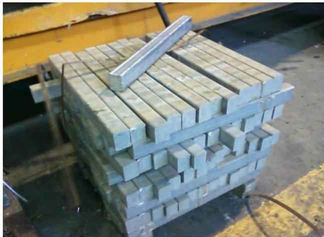
**Figure 16.**Lingot de l'alliage AS13 (Fonderie d'aluminium DFR-SNVI).
