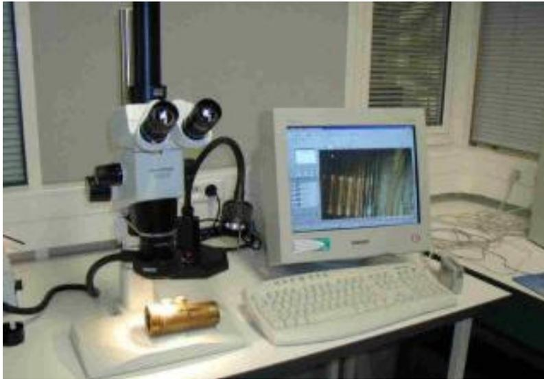
**Figure 22.** *Microscope muni d'une caméra et d'un ordinateur*
