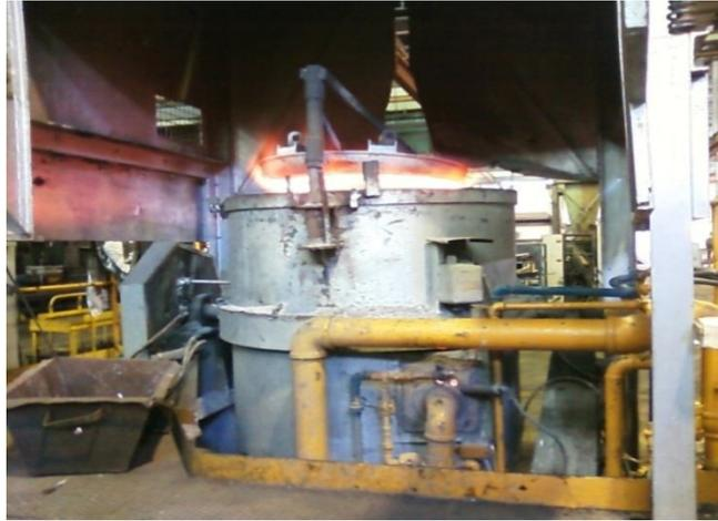
**Figure 15.** Four de fusion (Fonderie aluminium DFR-SNVI).
