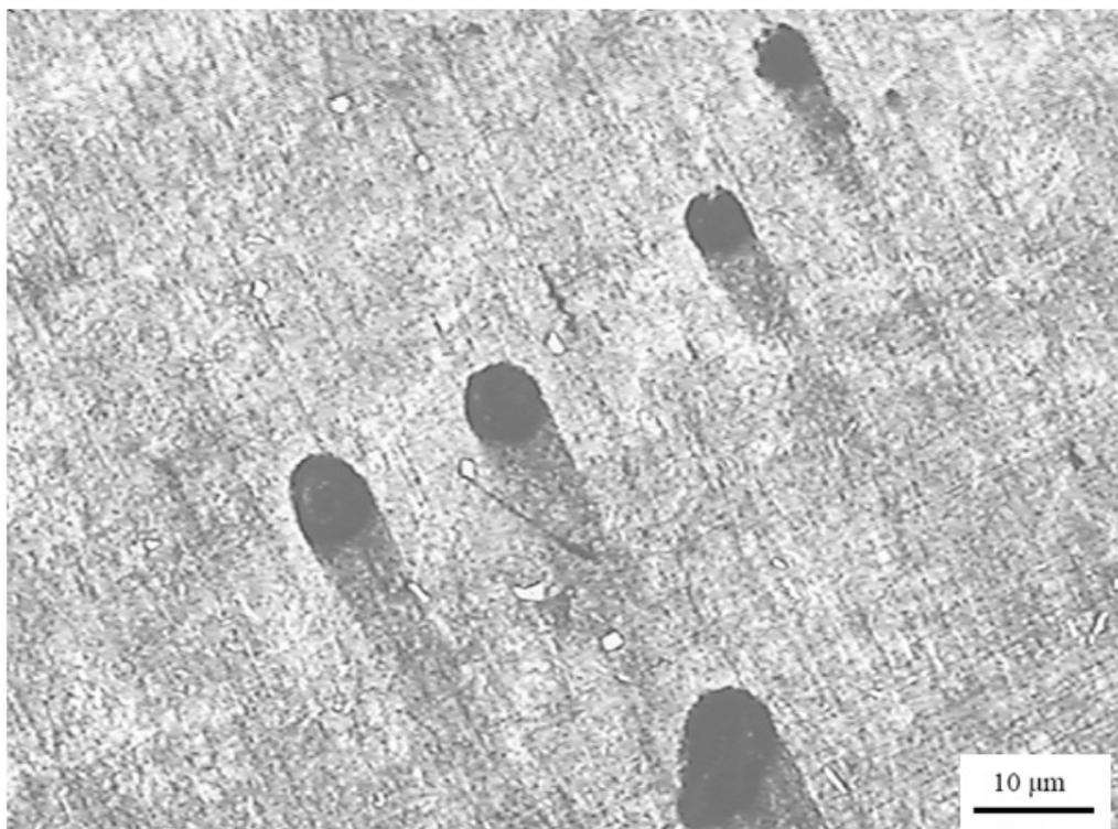
**Figure 27.** Microstructure montrant l'alliage AS13 coulé du four de maintien après 48h, selon un taux de porosités de 08,09 %.
