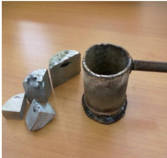
**Figure 20.***creuset et la pièce moulée.*
