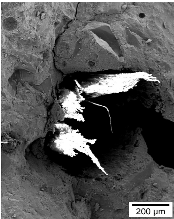
Figure 4-12: Photo au MEB d'un échantillon de béton extrait de la zone d'interface fibre-matrice du béton de fibres BF2 conservé dans l'eau durant trois mois
