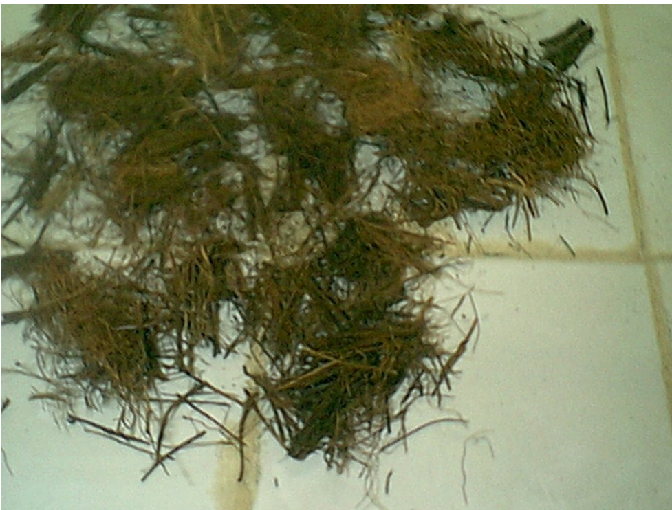
Photo 3-2 : Fibres de surface de palmier dattier individuelles après dé-fibration et lavage
