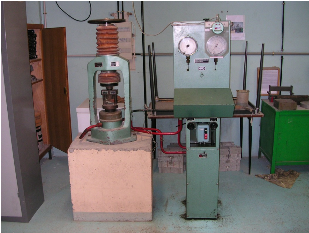
Photo 4-7 : Machine de compression utilisée pour le mortier
