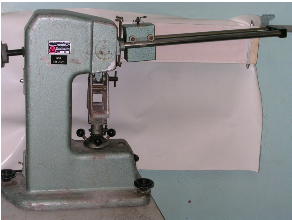
Photo 4-8 : Machine de flexion utilisée pour le mortier
