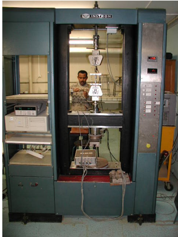
Photo 4-1 : Machine de traction universelle « INSTRON » utilisée pour l'essai de traction
