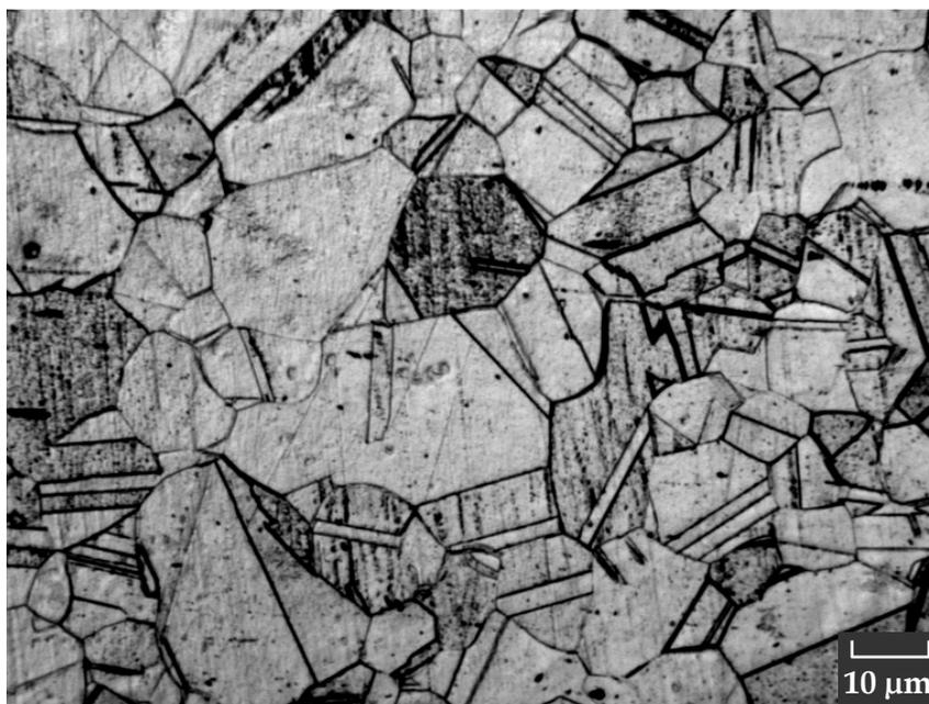
**Figure V. 3 :** Microstructure de l'acier 316L ( $1100^{\circ},30'$  +  $925^{\circ},300'$ ) prise au microscope optique après attaque chimique au Nital.
