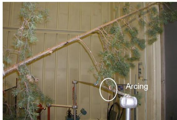
Figure I.24 : *Mode expérimental pour initier l'arc.*
