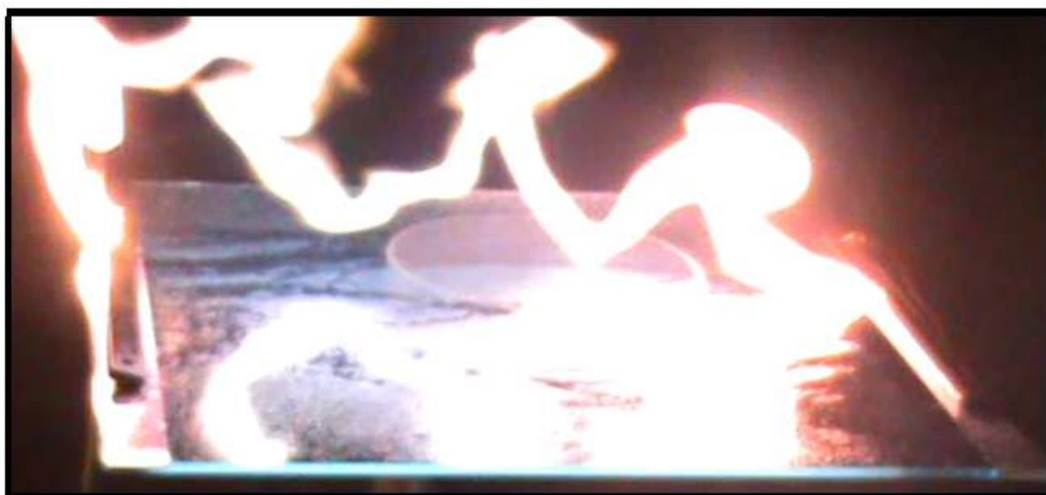
Figure IV.4: Comportement du modèle plan dans le cas d'une pollution non uniforme ( \gamma_{\text{vol}} = 1.2 mS/cm) et pour une largeur de la couche sèche d = 2 cm: (a) niveau de tension 52 kV; (b) niveau de tension 70 kV; (c) tension du contournement 97 kV.
