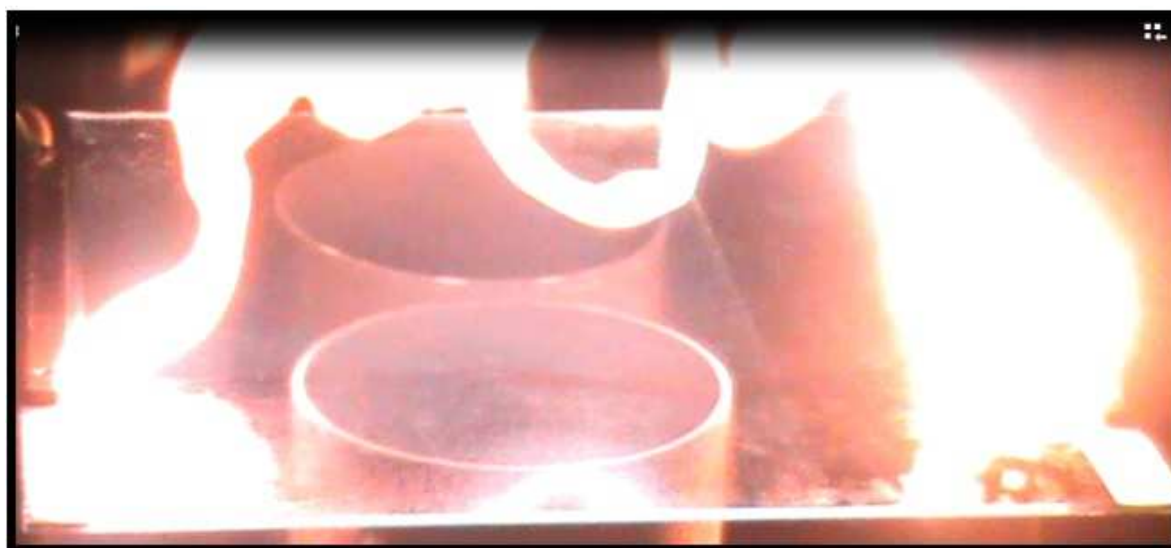
Figure IV.5 : Contournement sur le modèle plan dans le cas d'une pollution non uniforme ( \gamma_{\text{vol}} = 1.2 mS/cm) et pour une largeur de la couche sèche d_{\text{critique}} = 12 cm
