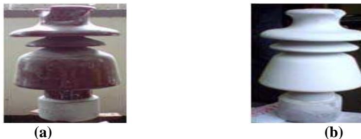
Figure I.13: Échantillon d'isolateur avant revêtement (a) et après revêtement (b).
