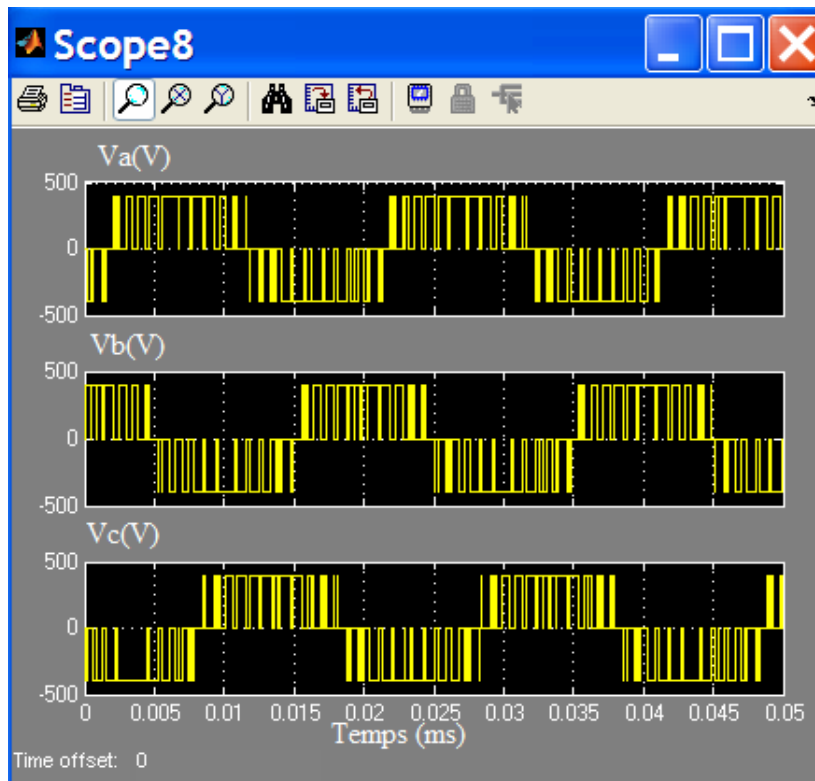
Fig.3.12 : Tension à la sortie de l'onduleur
