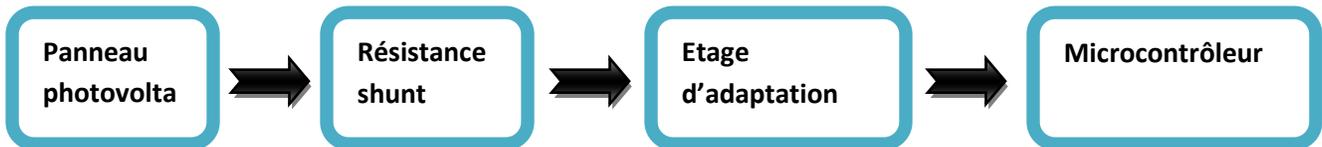
Figure 3.18 : Chaîne d'acquisition de courant
