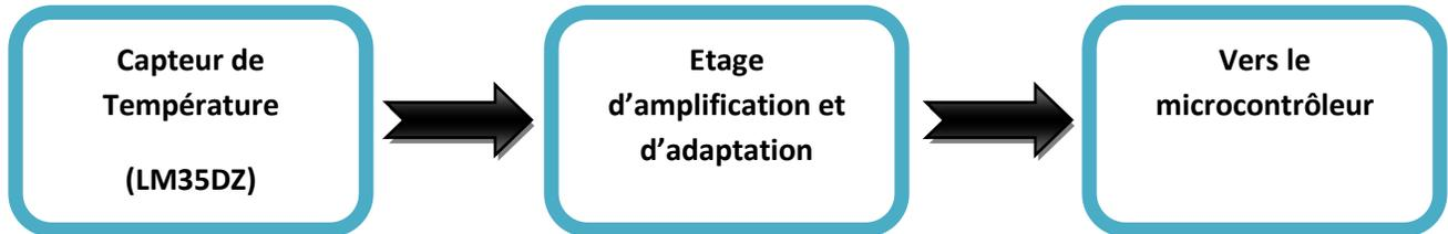
**Figure 3.10** : chaîne d'acquisition de la température
