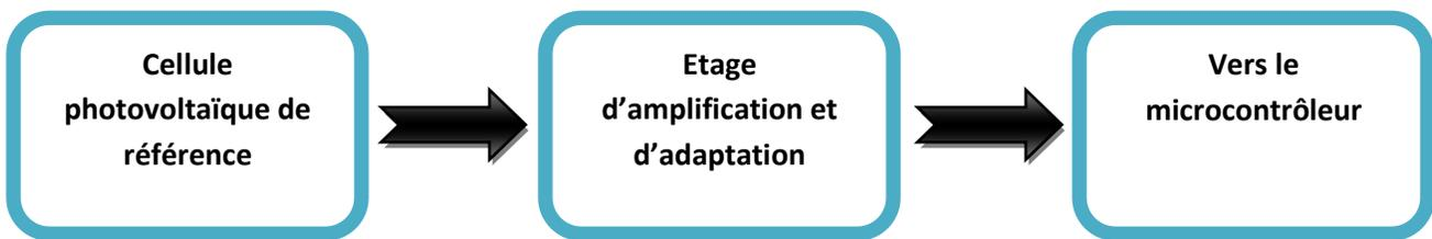
**Figure 3.14 :** chaine d'acquisition d'ensoleillement
