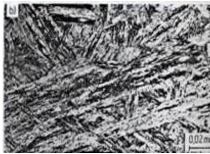
Figure 8. Exemple typique de la structure martensitique. [6]
