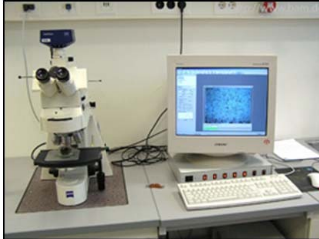
Figure III.5: Microscope optique muni d'une caméra numérique connecté à un micro-ordinateur.
