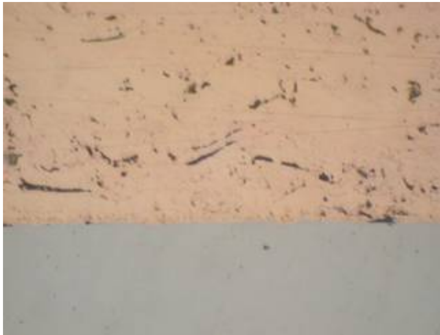
Figure I-13 : Dépôt de CuSn6Ag1 élaboré par projection arc-fil sur acier. [7]
