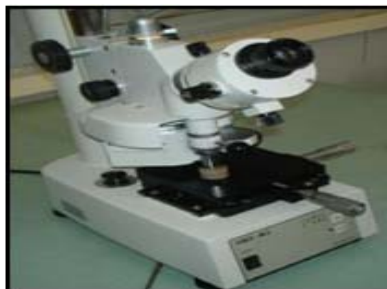
Figure III-7: Microduromètre INSTRONWOLPERT TESTOR.
