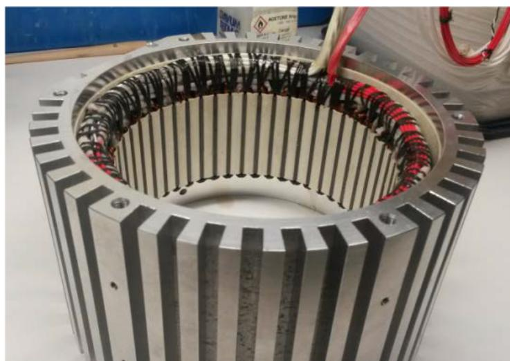
Figure 2.2 – La photo du stator bobiné intégré dans le carter
