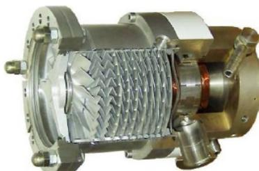
**Figure 1.4** – Coupe transversale d'une pompe turbo moléculaire entraînée par un moteur à grande vitesse [5].
