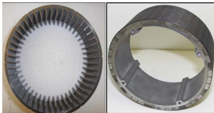
**Figure 2.1** – Photos du stator nu (à gauche) et du rotor muni des aimants et de la frète (à droite)
