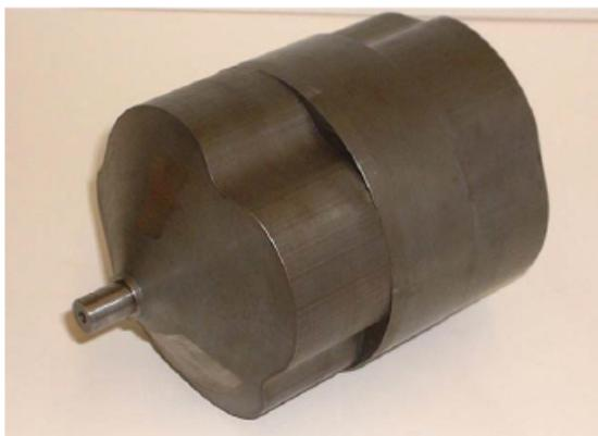
**Figure 1.15** – Rotor de machine homopolaire synchrone de 20 kW-crête 100 000 tr/min [10].
