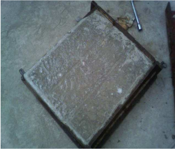
Béton de sable de dunes
