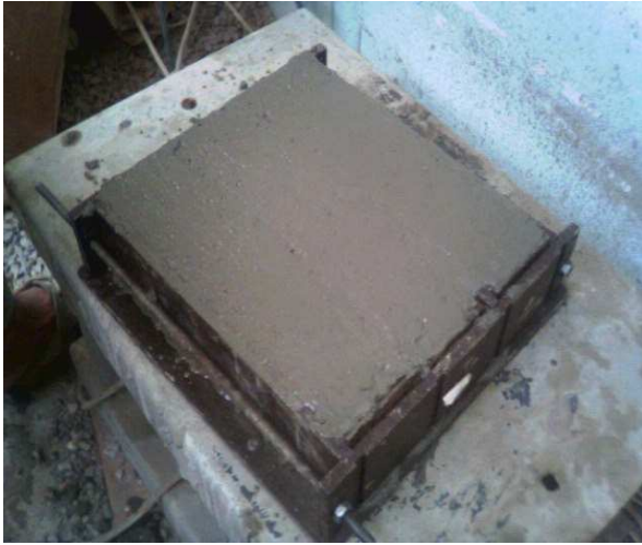
Vibration de béton de sable de dunes modifié par poudrette de caoutchouc.
