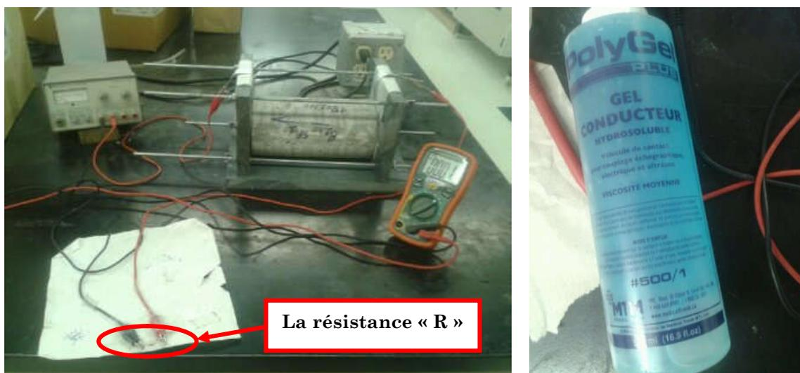
**Figure 2.16 :** Mesure de la résistivité électrique d'une éprouvette de béton
