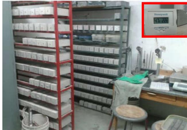
**Figure 2.17 :** conservation des éprouvettes de retrait de séchage et appareil de mesure
