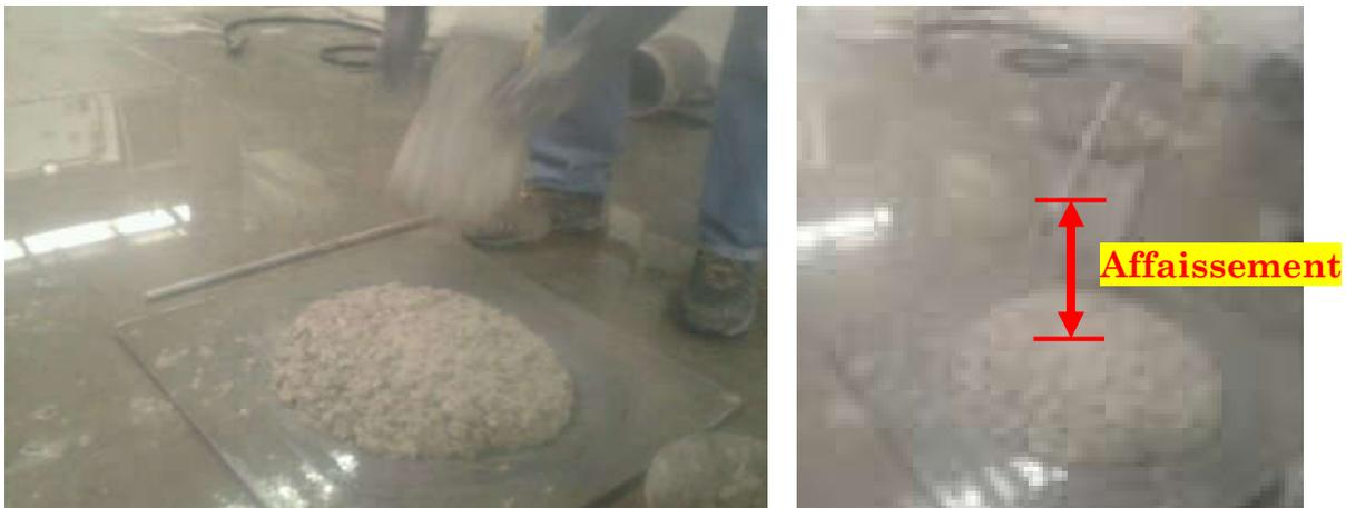
**Figure 2.11 :** *Mesures de l'affaissement du béton au cône d'Abrams*
