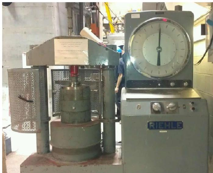
**Figure 2.10 :** Presse hydraulique pour l'essai de résistance à la compression des mortiers
