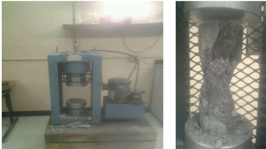
**Figure 2.13 :** Presse d'écrasement et éprouvette testée à la compression
