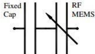
Figure III.4 schéma de la capacité variable
