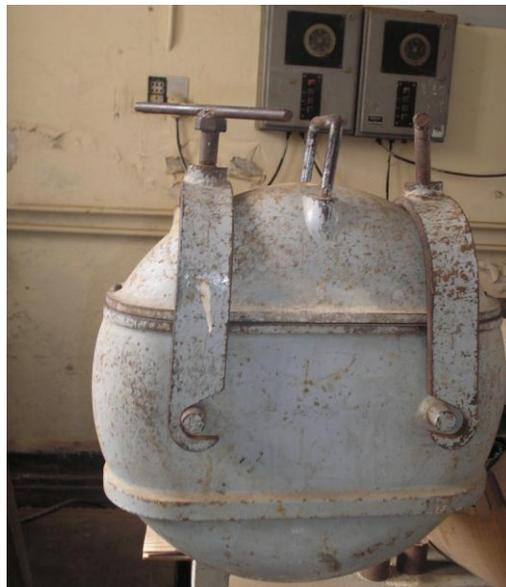
**Figure VI.2.** Photo réelle du broyeur à boulets utilisé.
