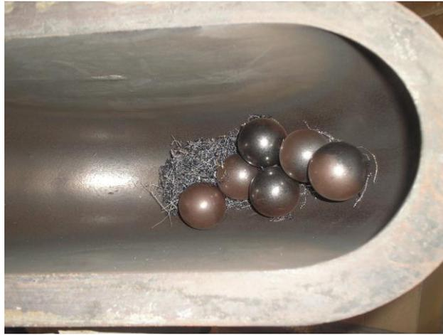
**Figure VI.3.** Charges broyante et broyée à l'intérieur de la chambre de broyage.
