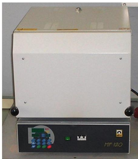
Figure VI.1. Photo réelle du four à moufles utilisé.
