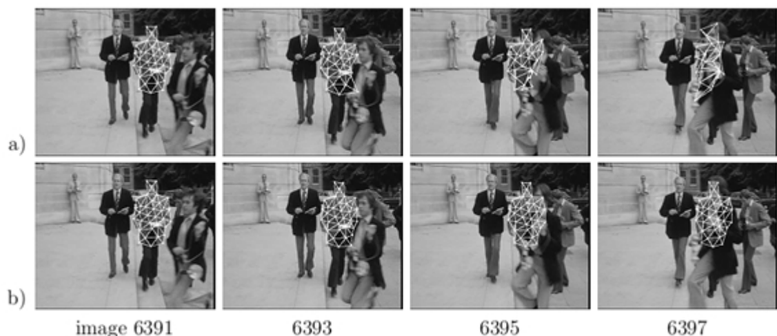
FIG II.22 : Suivi par maillage d'un personnage occulté, avec peu de rééité (a), et forte rééité (b)
