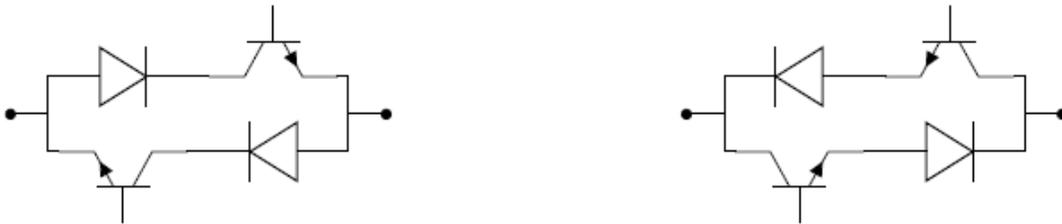
Figure 4.5: Topologie sans connexion centrale
