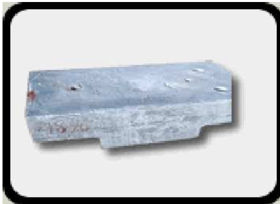
Figure I-5 : zinc jumbo de 02 tonnes Pré aluminé ; pré plombé
