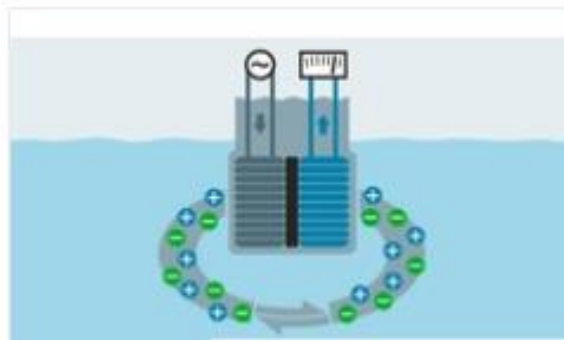
Figure 2. 12 Principe de fonctionnement d'une sonde de conductivité
