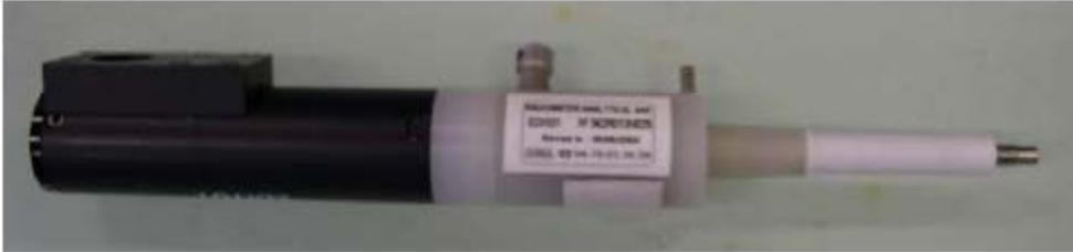
Figure 4.12 : Electrode à disque tournant.
