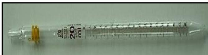
**Figure B.3:** La pipette utilisée pour prélever les volumes de liquide.
