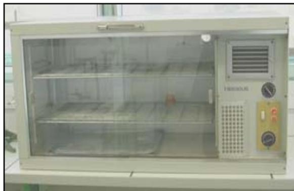
**Figure B.6:** Four-étuve utilisé pour sécher la poudre étudiée.
