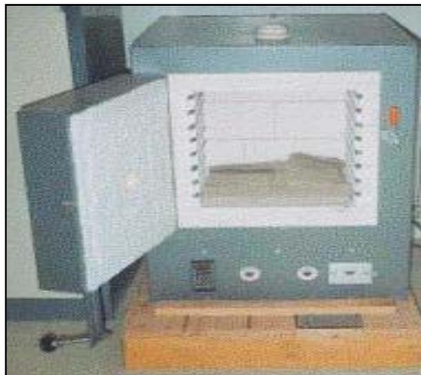
**Figure. B.9:** Four à moufle utilisé pour le frittage.
