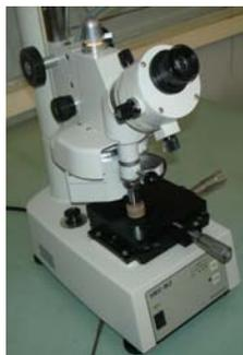
**Figure.B.14 :** Microduromètre SHIMATZU HMV-M3.
