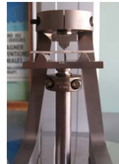
Figure 34. Porte-échantillon flexion trois points.
