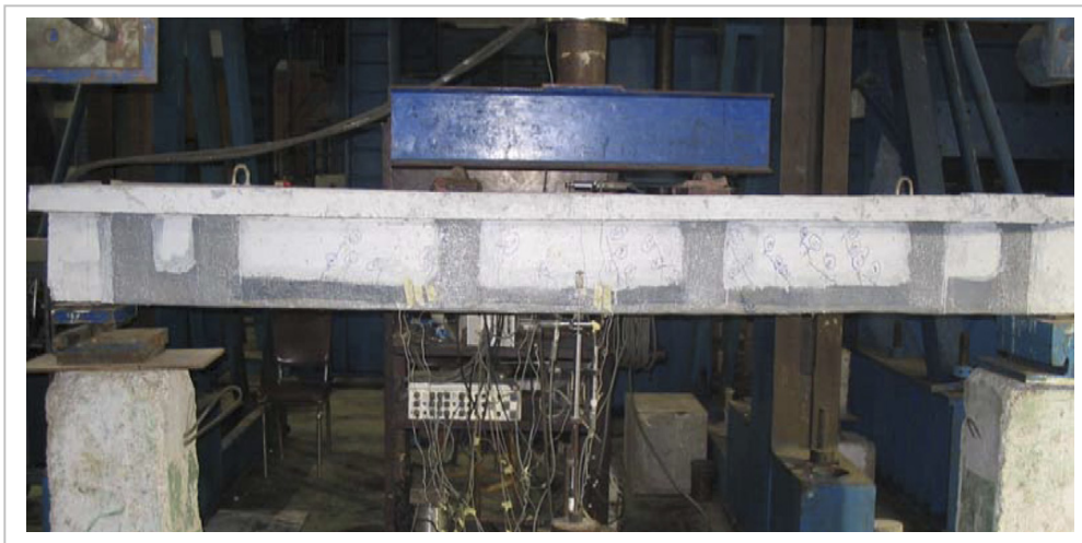
Figure I.30: Test flexion 4 points d'une poutre en T [38].
