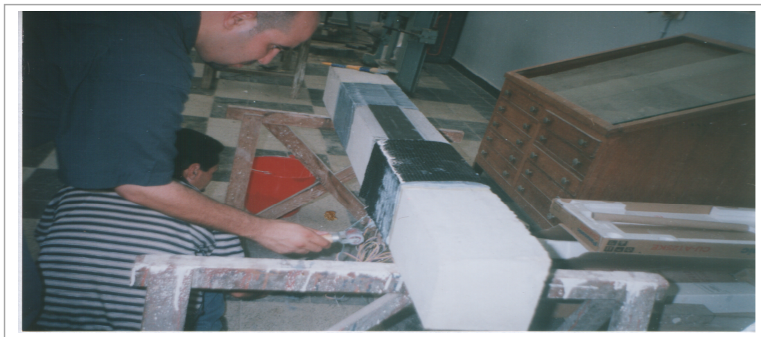
Figure II.16: Pose des composites pour la poutre RP4
