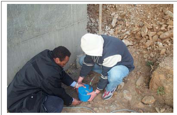
Figures II.30 et II.31 : Ajustement et emplacement du capteur au fond de la pile
