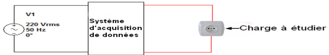
Figure II.2.1. Schéma du montage expérimental pour l'étude des charges.
