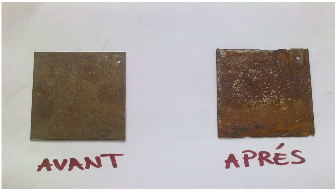
Photo V.1 : Electrodes anodiques en Al (a) et Fe (b) avant et après traitement
