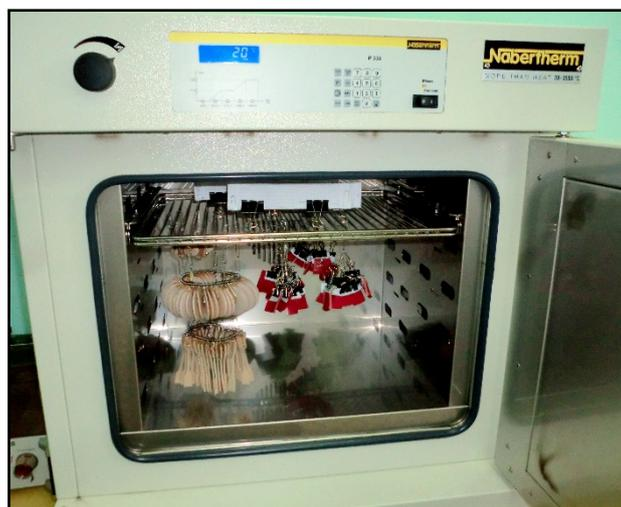
Figure II.1. Disposition des échantillons à l'intérieur de l'étuve (ENP)
