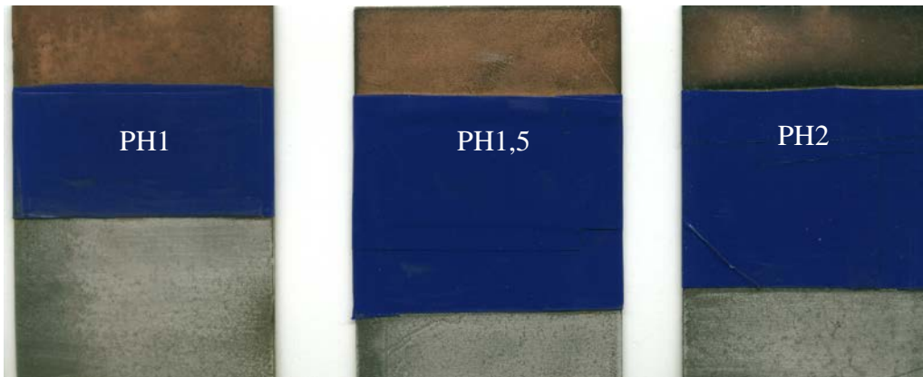
Régénération provoquée de la biomasse traitée- Effet du pH de l'éluant: Aspect des cathodes.
