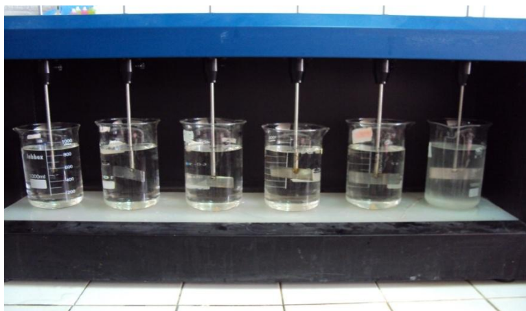
Figure 15 : Schéma du dispositif expérimental de coagulation chimique.
