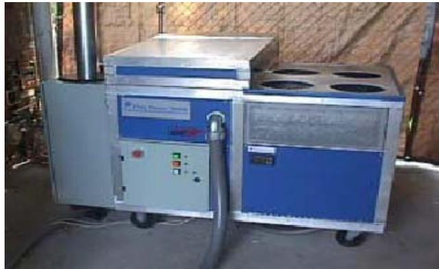
Figure 2.2 : Photo de PEMFC de 7kW pour applications résidentielles [34]
