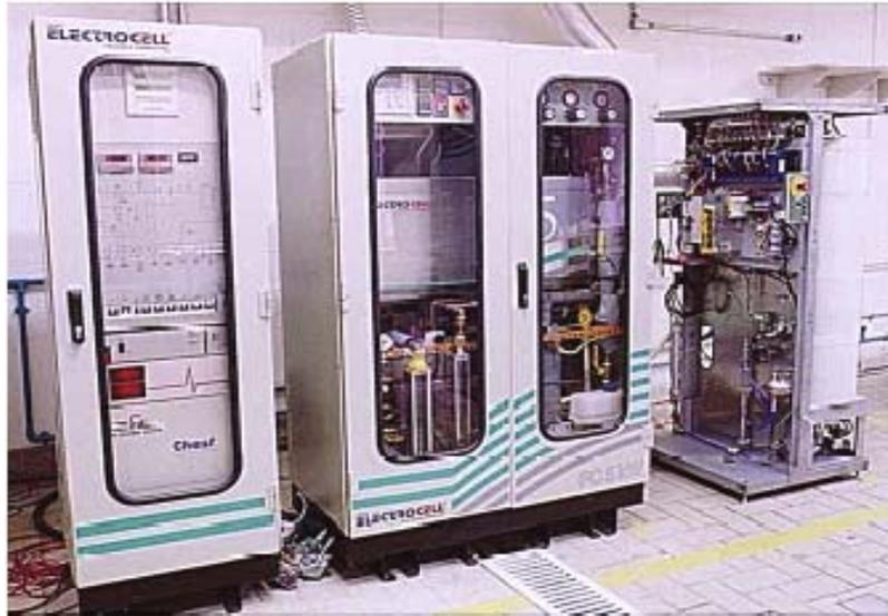
Figure 2.7 : Photo de piles PEMFC utilisées en cogénération et alimentées en gaz naturel [52].
