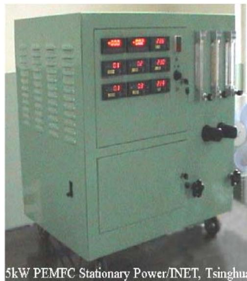
Figure 2.5: Photo d'une pile PEMFC de 5kW pour les applications stationnaires [49].
