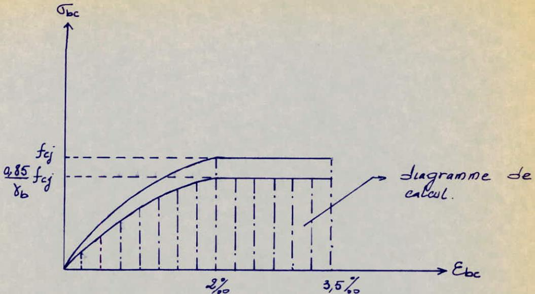
Le coefficient de sécurité  $\gamma_b$ , tient compte d'éventuels défauts localisés, ainsi que de la réduction possible de la résistance mise en œuvre par rapport à sa résistance caractéristique défini à priori.
