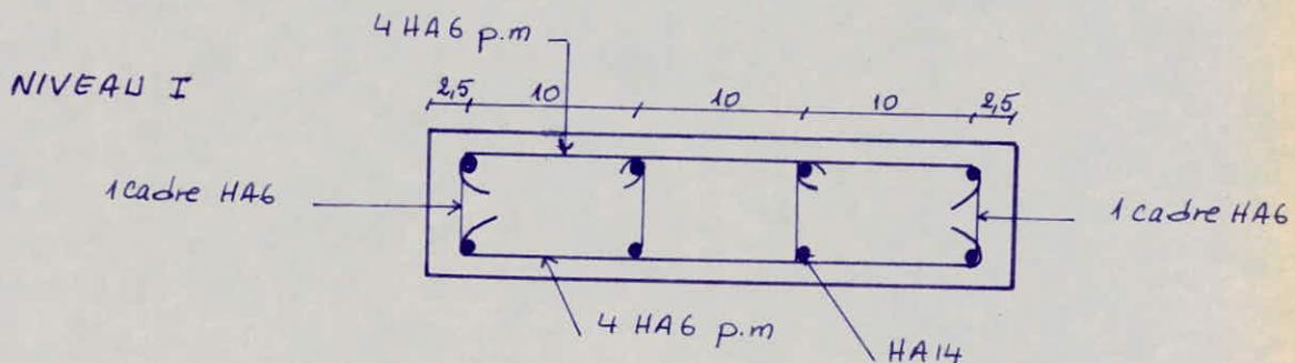
Remarque: pour les niveaux II et III on aura la même disposition à part que le diamètre des armatures verticales change.
