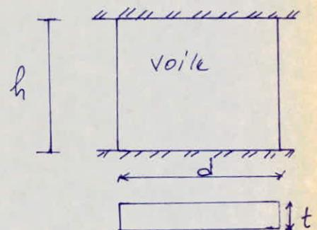
Les voiles avec files d'ouvertures sont modélisées comme trumeaux et linteaux et par conséquent leur déplacement total est calculé comme suit
