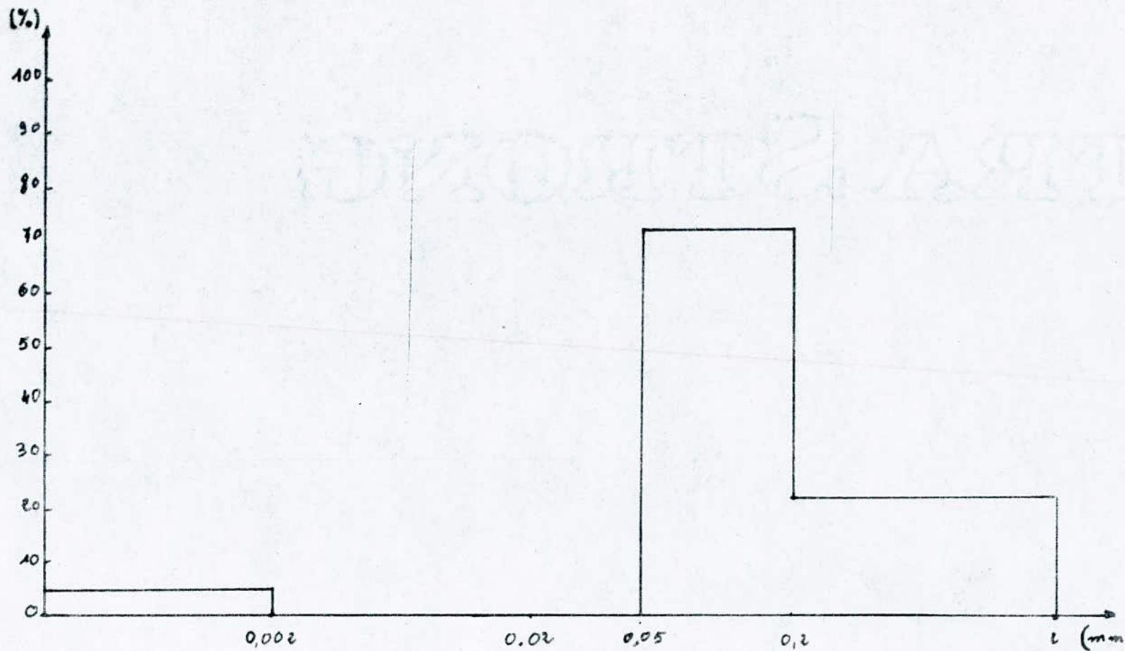
fig-2.8 - Distribution granulométrique du sable
