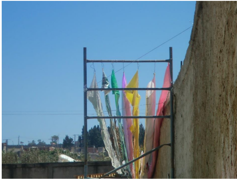
Figure II.1: Echantillons de toiles tissées en PP exposées.
