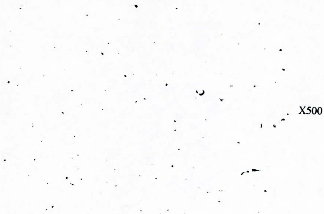
Figure ( 6.7 ) : Photomicrographie montrant le volume de la porosité d 'un échantillon comprimé à 400 bars et fritté pendant 1 heure à 770°C.
