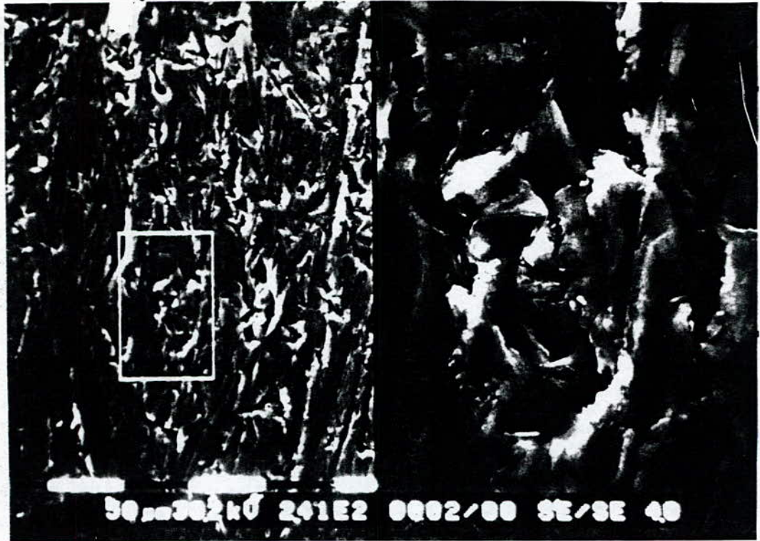
Fig (3.6): Partie traitée de l'échantillon anodisé à 1.3 V (Grossissement moyen)
