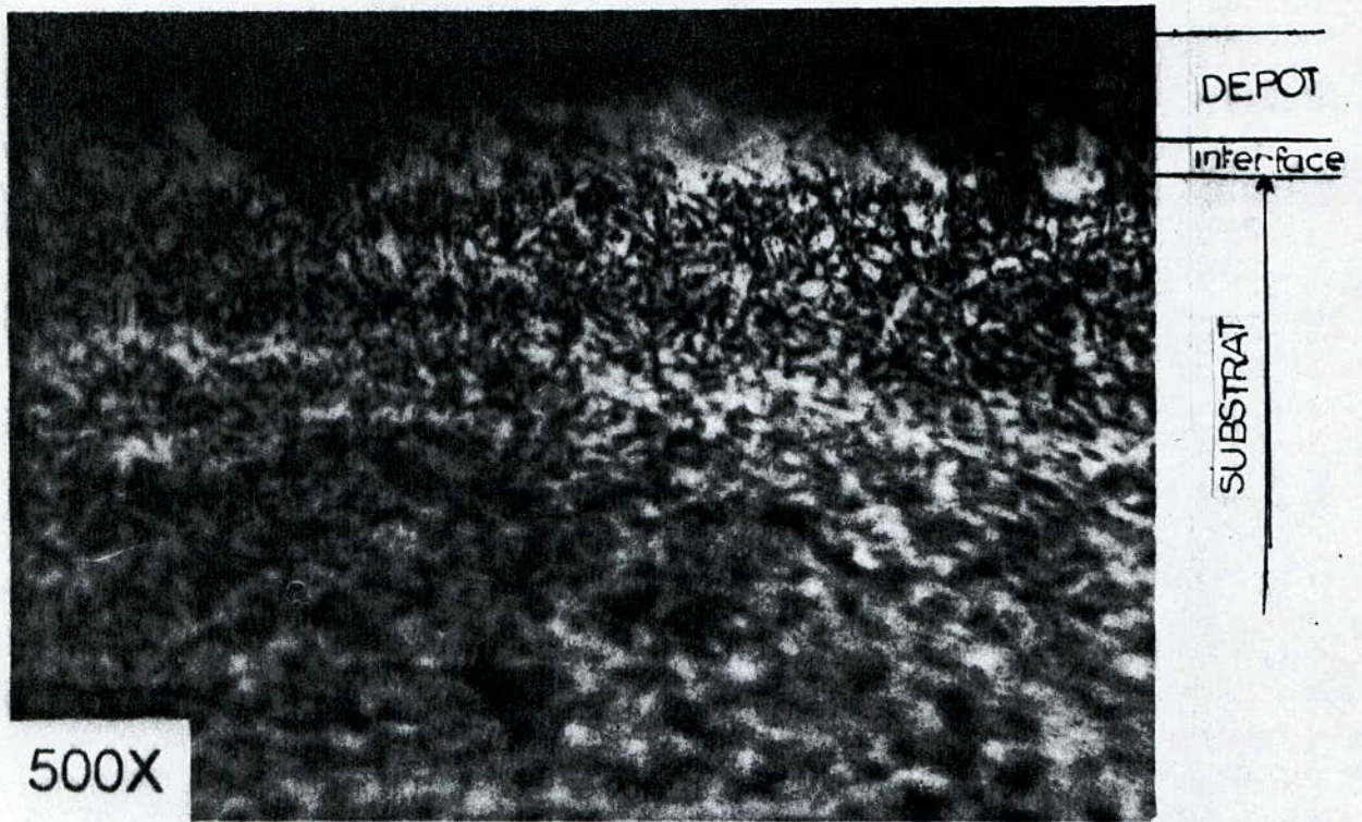
Fig 31: Interface du couple Cu-Sn-Ni/XC10 (traité à 630°C, pendant 15H). Photo optique avec attaque chimique.
