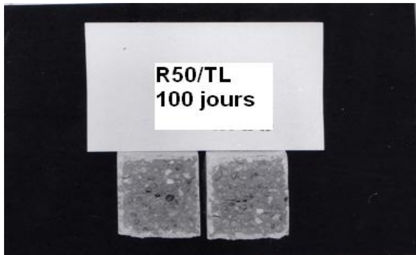
Photo 4.1a : Surface d'un prisme brisé avec 50% remplacement de laitier et traité dans le laboratoire (durée 3 mois)
