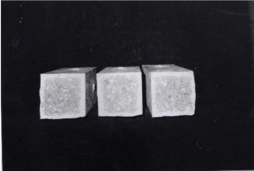
Photo 4.3a: Surface d'un prisme brisé 100 x 100 x 500 mm avec 50% de remplacement traité dans le laboratoire (durée 6 mois)
