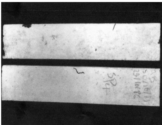
Photo 4.3b première fissure visible pour 65 % de laitier
