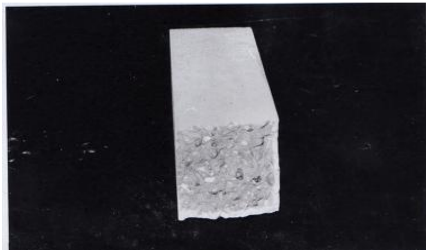
Photos 4.2a : Surface d'un prisme brisé avec 50% remplacement de laitier et traité 7 jours dans la chambre humide (durée 3 mois).
