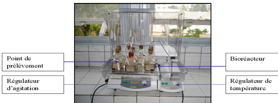
Figure VI.1 - Incubateur servant à la mesure de la DCO et la croissance microbienne.
