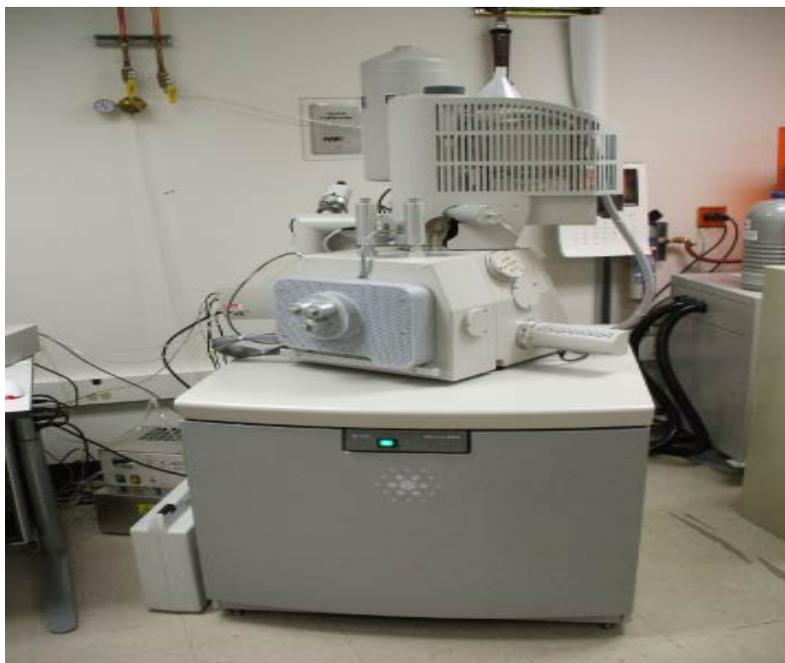
**Figure 3.26:** Photo du MEB de marque Quant A600 FEI.
