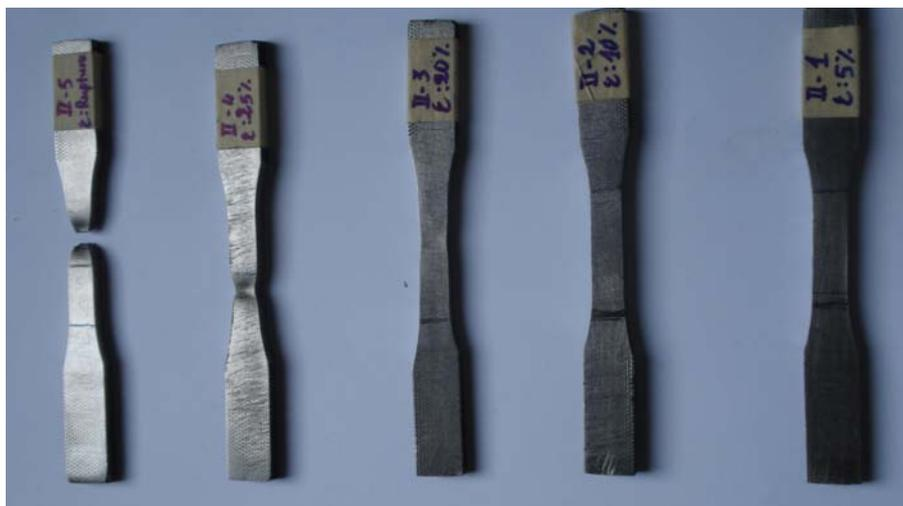
**Figure 3.20:** Eprouvette de traction déformée à 5, 10, 20, 25, 30% et rupture.
