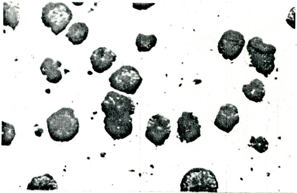
Fonte G.S.C alliée à 1% de nickel. G = 200 sans attaque
