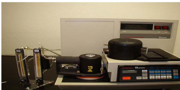
**Figure 4 .3: Image de l'appareil de calorimétrie différentielle à balayage
