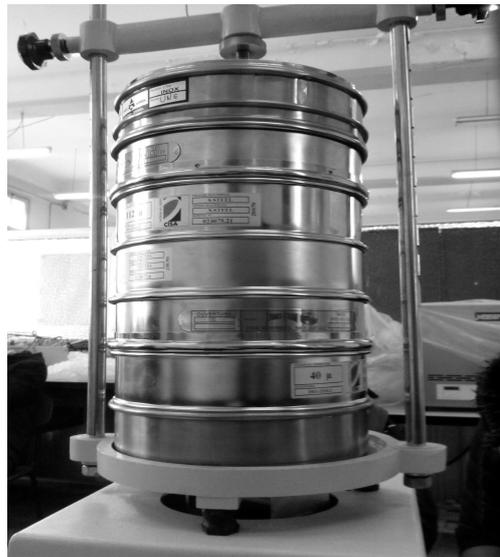
Fig 3.1. Tamiseuse utilisé pour la caractérisation .
