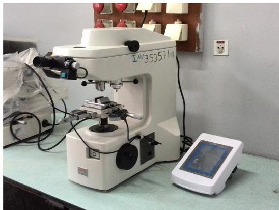
**Fig 3.10.** Microduromètre.
