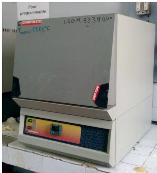
Fig 3.6. Four à moufle utilisée pour le frittage des capsules.
