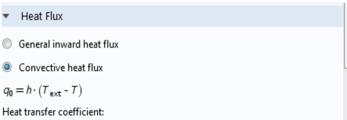
Figure IV.6: capture d'écran des équations utilisées pour le calcul du transfert thermique de convection
