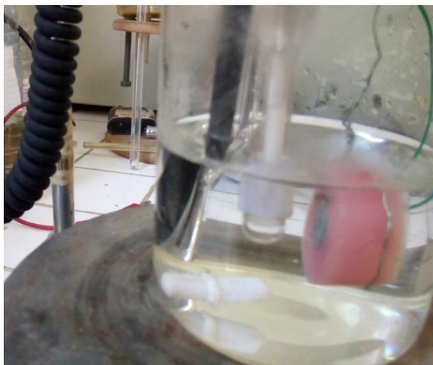
FIGURE 4.6 – la surface d'échantillon en parallèle avec l'électrode de référence.
