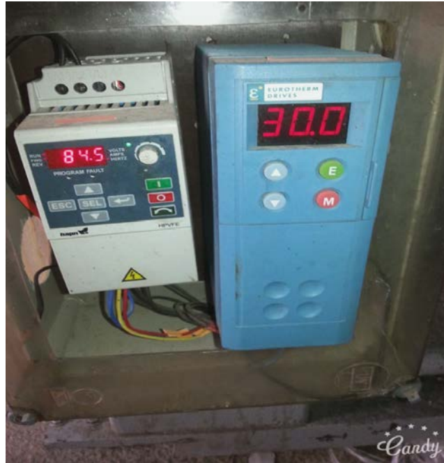
Figure II.5 : Réglage des fréquences de translation et de rotation.
