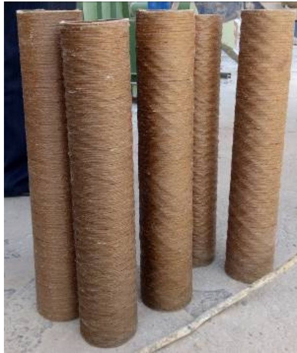
Figure II.7 : Tubes composites jute/époxy réalisés.
