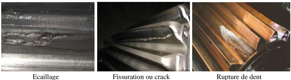
Figure 1.9 : Défauts localisés sur différentes dentures [24, 25].
