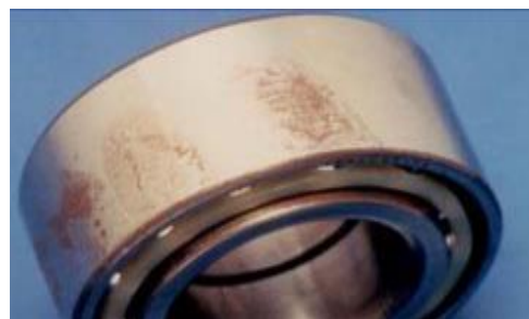
(b) Apparition de zones de corrosion
