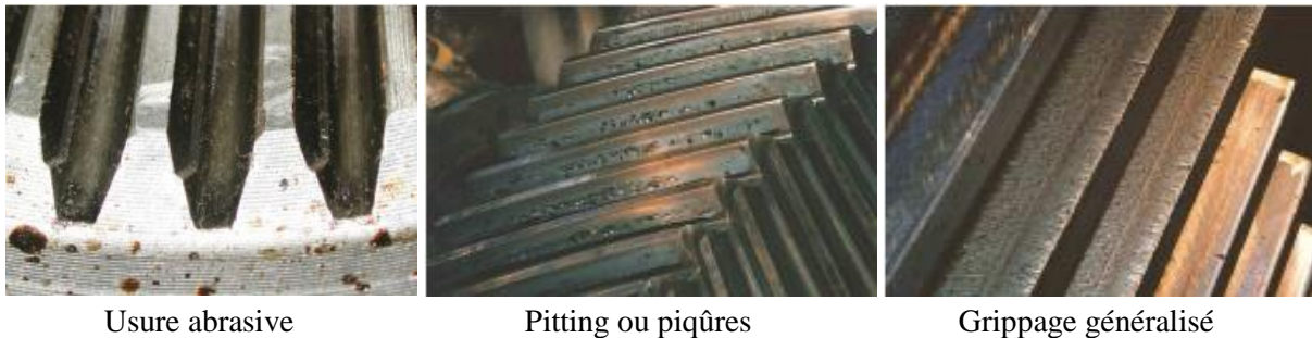
Figure 1.8 : Défauts généralisés sur différentes dentures [24].
