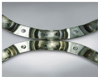
Figure 1.22 : Éraflures de cage d'un roulement à billes à gorge profonde [30]
