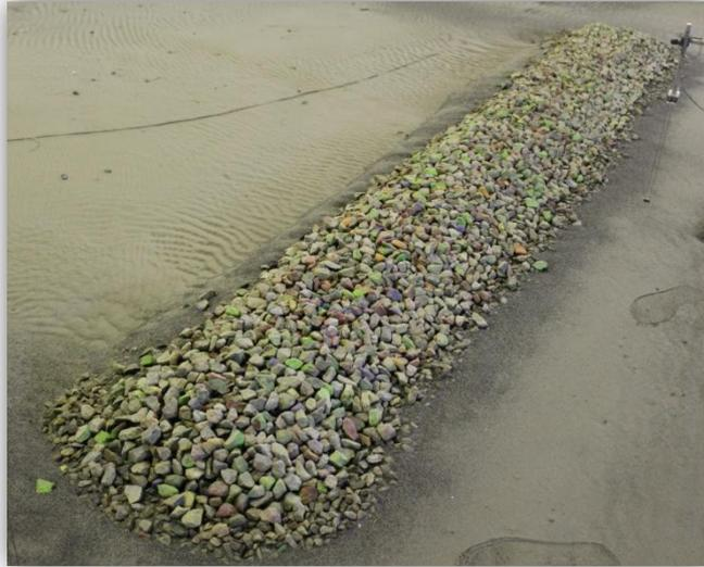
**Photo III.23:** Photo du brise-lames BL1 après les essais de stabilité.
