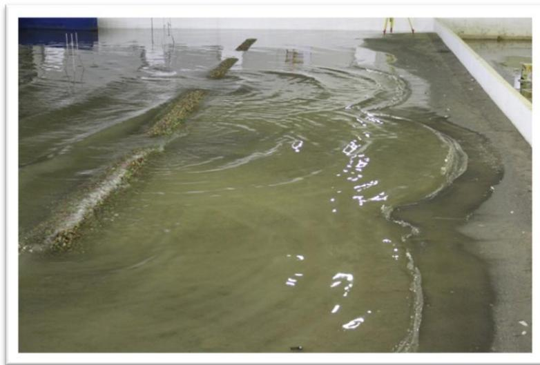
**Photo III.21** : Essais de la houle cinquantennale de la direction N45°.
