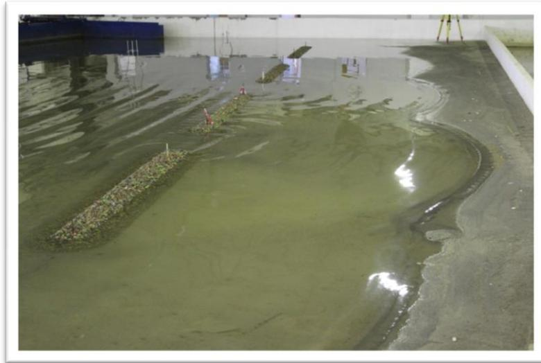
**Photo III.14** : Essais du cycle 4 : houles de la direction N60°.
