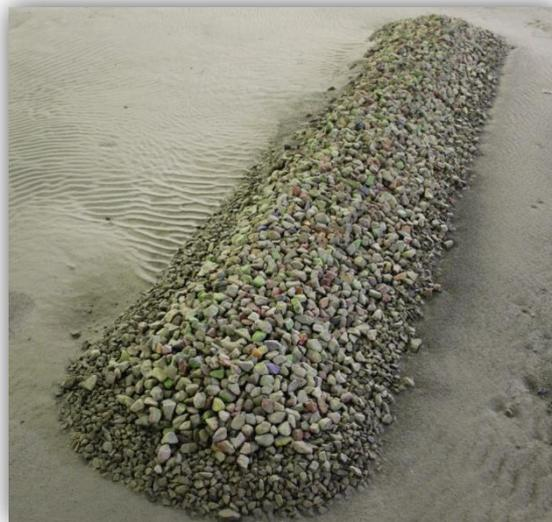
**Photo III.25:** Photo du brise-lames BL3 après les essais de stabilité.
