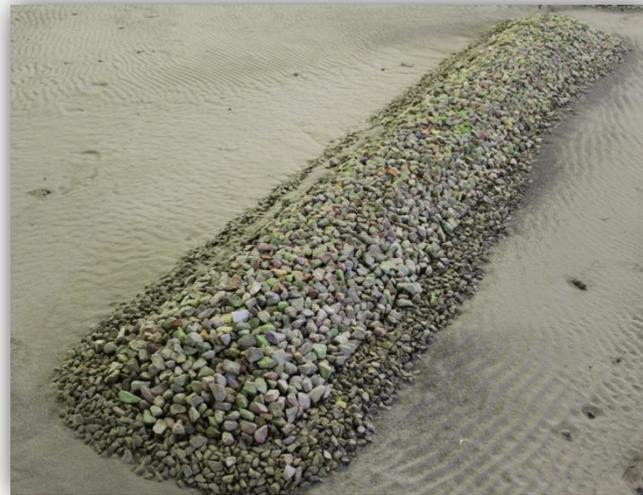
**Photo III.24:** Photo du brise-lames BL2 après la série d'essais de stabilité.
