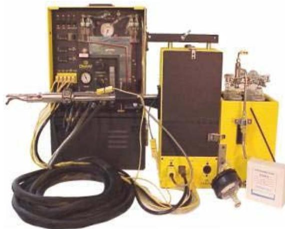
**Photo 6** : Echantillonneur isocinétique, de la firme Clean Air Europ
