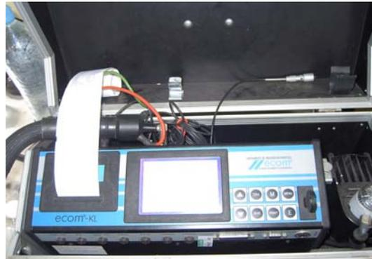
**Photo 5** Analyseur des gaz de combustion
