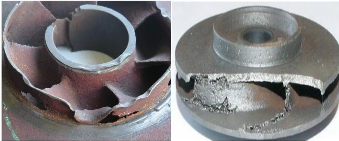
Figure V.7 Pompes centrifuges détruites par la cavitation
