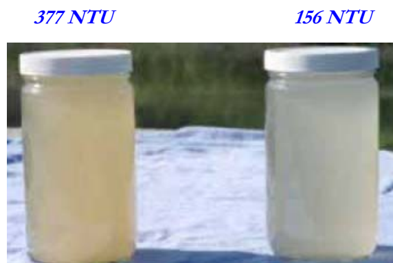
Figure V-7: Décantation naturelle après 30 minutes
