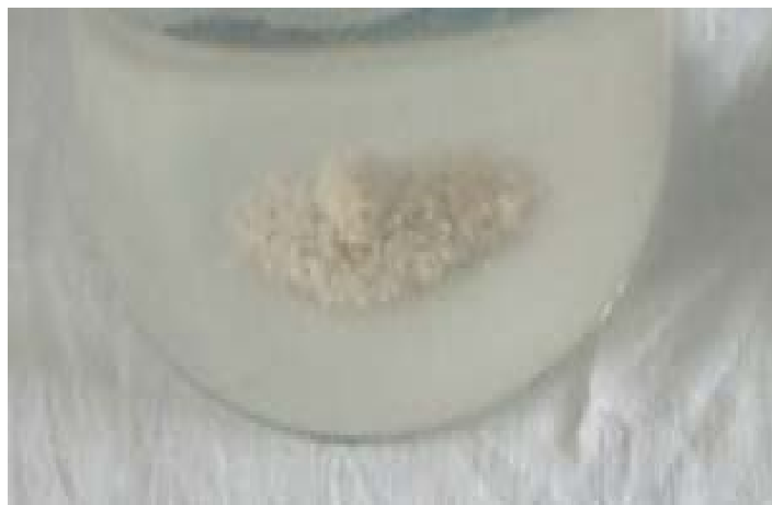
Figure V-22 : Floccs formés lors de l'application du flocculant de synthèse
